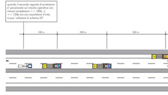
24 CANTIERE IN LENTO AVANZAMENTO. CHIUSURA DELLA CORSIA DI MARCIA
