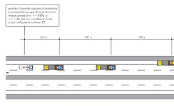
23 SEGNALETICA MOBILE A PROTEZIONE DI VEICOLI SPECIALI IMPIEGATI PER LAVORI, CONTROLLI, SONDAGGI E VERIFICHE DI RAPIDA ESECUZIONE. CHIUSURA DELLA CORSIA DI SORPASSO
