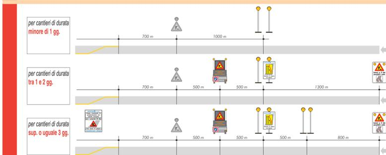
22\* SEGNALETICA MOBILE A PROTEZIONE DI VEICOLI SPECIALI IMPIEGATI PER LAVORI, CONTROLLI, SONDAGGI E VERIFICHE DI RAPIDA ESECUZIONE. CHIUSURA DELLA CORSIA DI MARCIA
