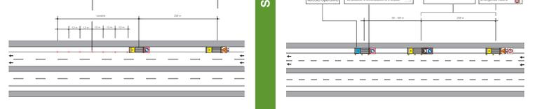
22 SEGNALETICA MOBILE A PROTEZIONE DI VEICOLI SPECIALI IMPIEGATI PER LAVORI, CONTROLLI, SONDAGGI E VERIFICHE DI RAPIDA ESECUZIONE. CHIUSURA DELLA CORSIA DI MARCIA
