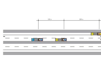
25 CANTIERE IN LENTO AVANZAMENTO. CHIUSURA DELLA CORSIA DI SORPASSO
